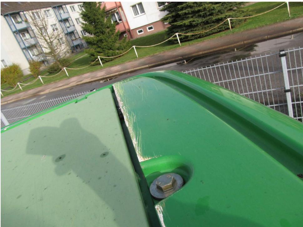
Bild 6: Dach hinten links erheblich abgeschrammt
