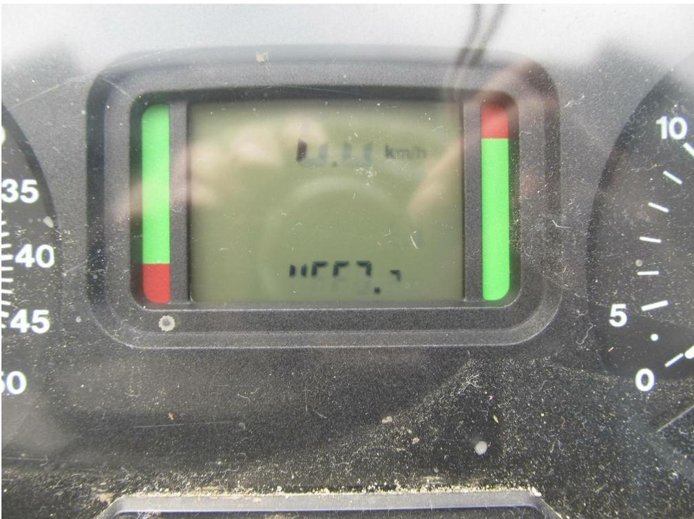
Bild 10: Anzeige mit Pixelfehler
