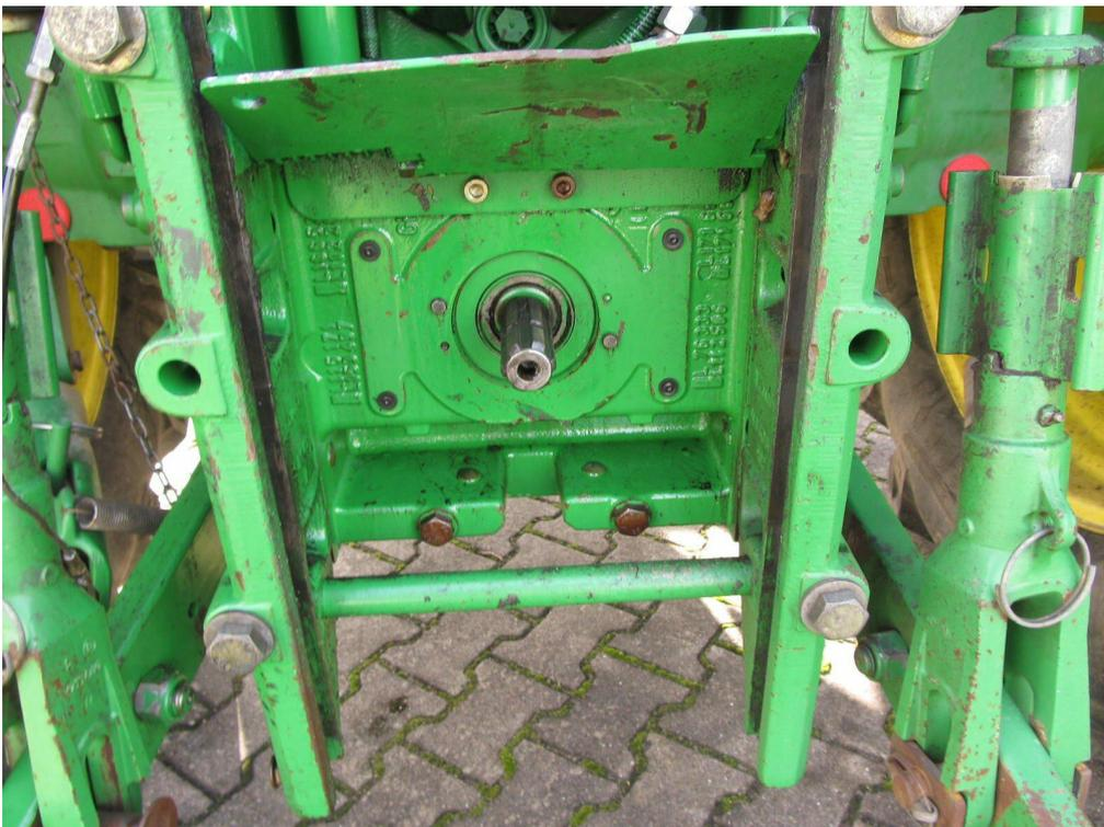
Bild 8: Zapfwelle ölfeucht
