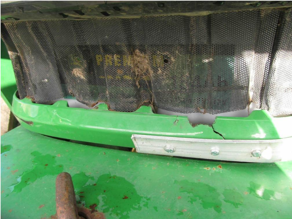
Bild 7: Grill und Motorhaube eingedrückt u. eingerissen
