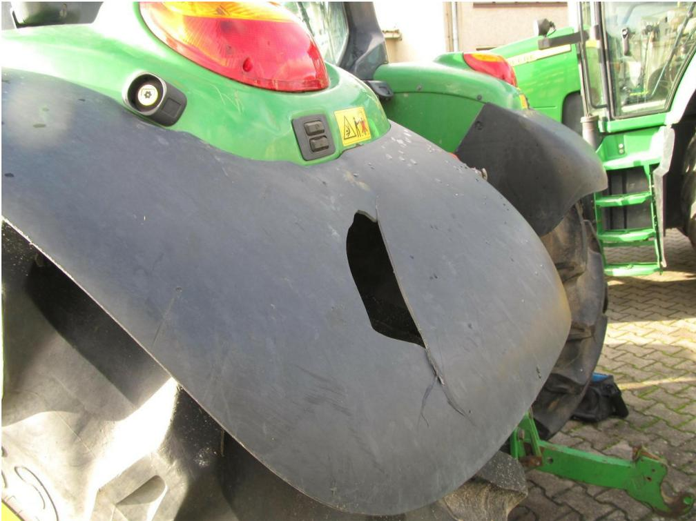
Bild 9: Kotflügel hinten links gerissen
