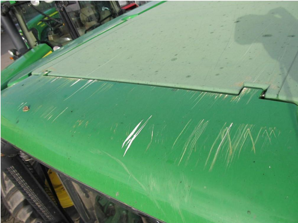
Bild 5: Dach abgeschrammt
