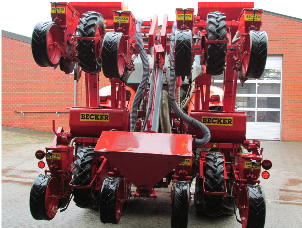
Bild 1: Becker Maislegemaschine 8 Reihig
