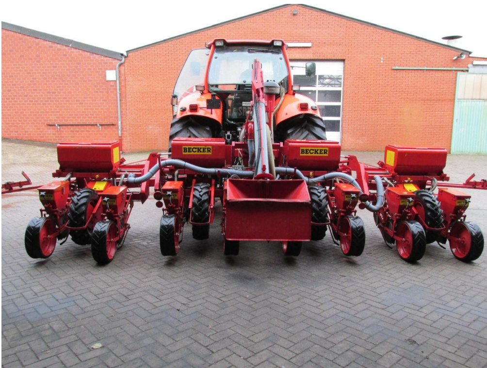
Bild 6: Sechs Meter Arbeitsbreite
